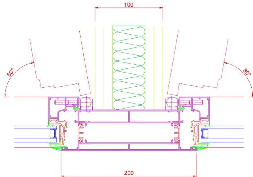
**- Détail sur montant intermédiaire avec cloison -**
