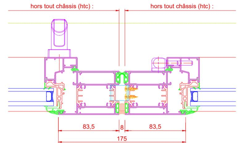
**- Jonction châssis par emboîtement pour dilatation -**
